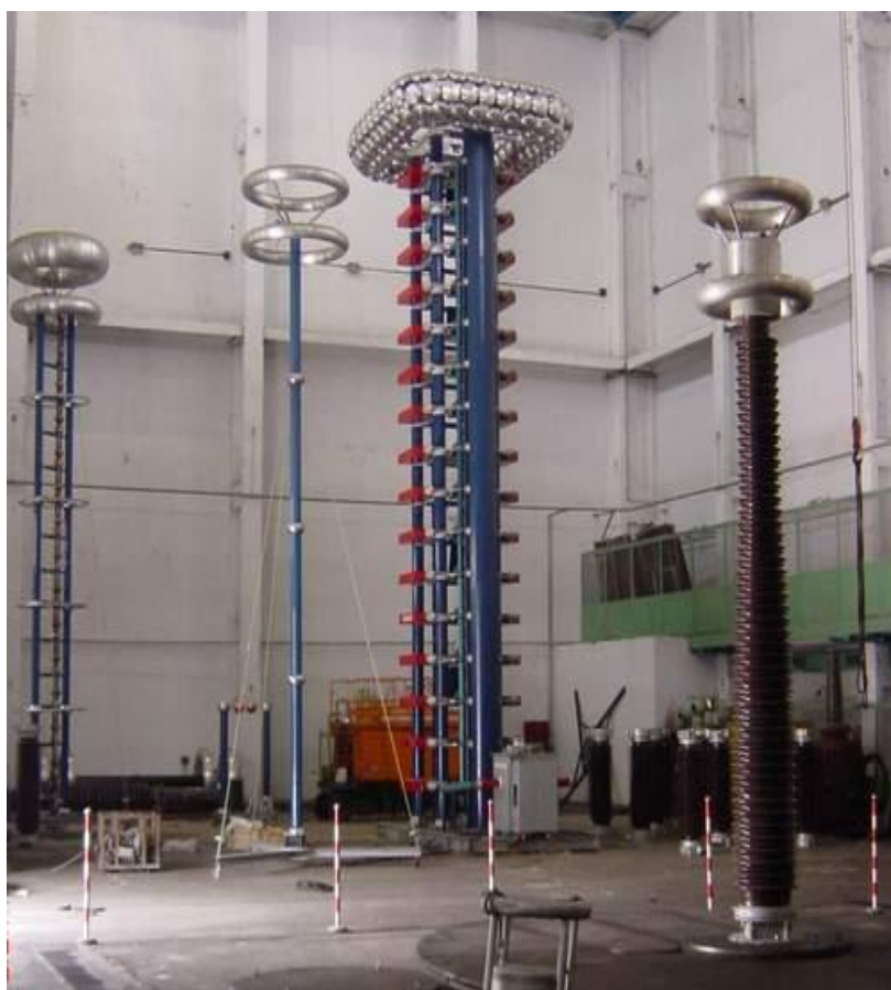
图 3 3200kV 冲击电压试验系统
